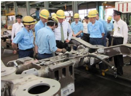
台車枠の磁粉探傷検査（社長）
