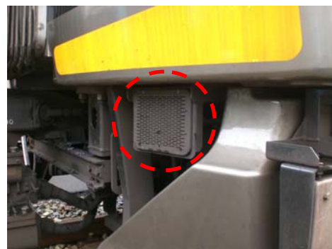
【破線内が転落防止放送装置】
